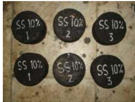
Gambar 3.4 Spesimen kadar Serat TKKS 10%
