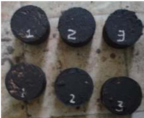
Gambar 3.1 Spesimen aspal murni
