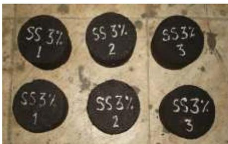
Gambar 3.2 Spesimen Kadar Serat TKKS 3 %
