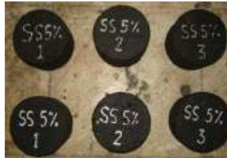
Gambar 3.3 Spesimen kadar Serat TKKS 5 %
